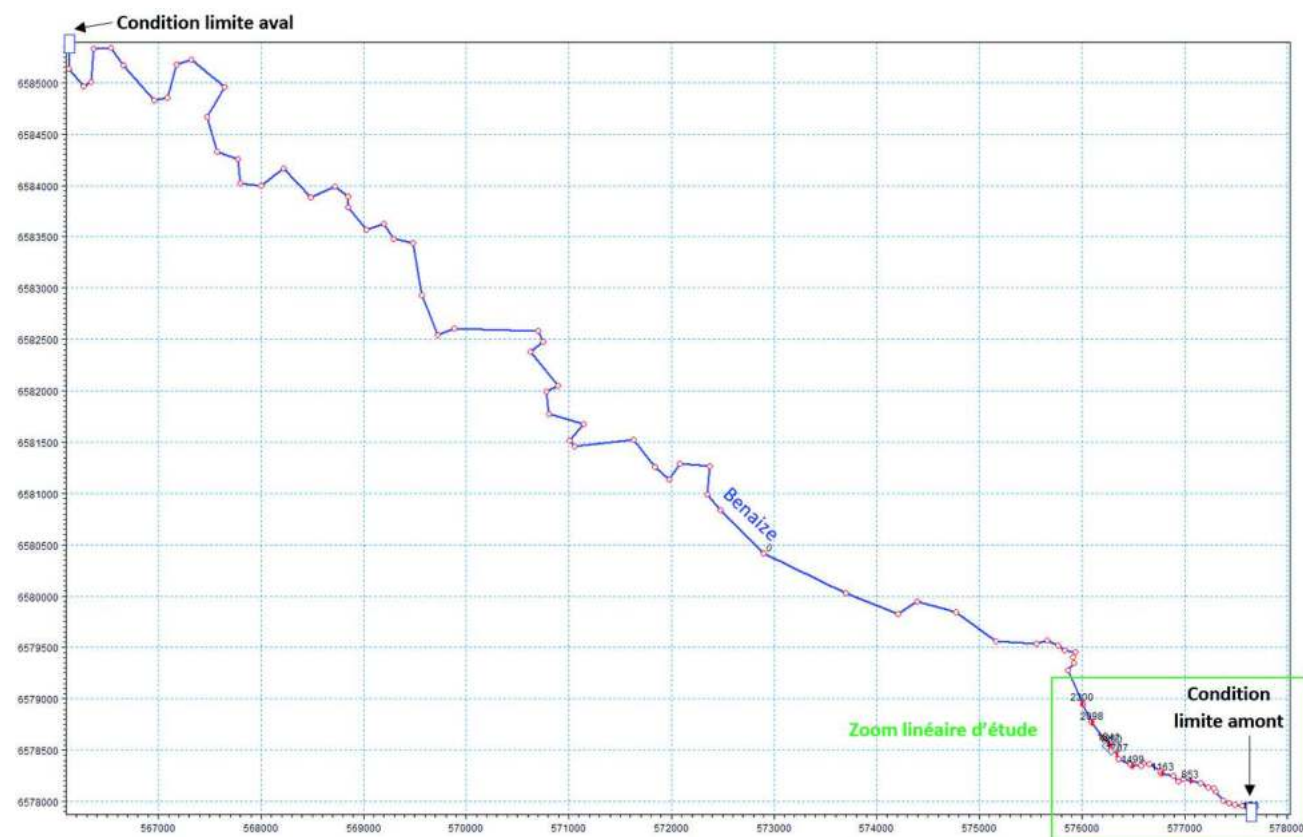
Figure 10 : Schéma topologique du modèle en état initial sous Mike 11 (source : Antea Group)
